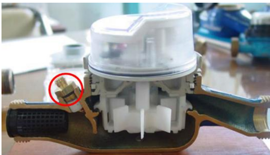
Detalhe do parafuso regulador do hidrômetro velocimétrico
