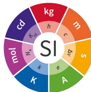
Figura 2 SI Illustration Representação gráfica do SI incluindo as unidades de base e as correspondentes constantes fundamentais que as definem [3].
