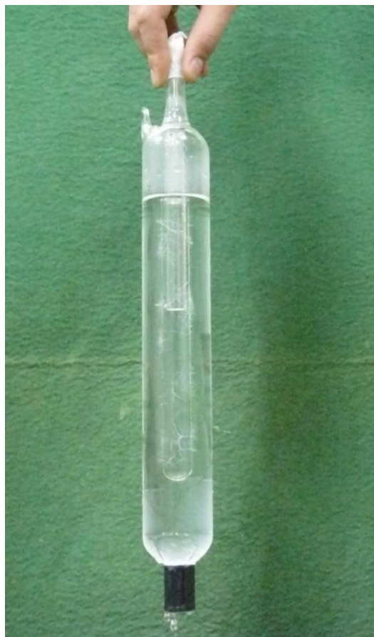
Figura I Célula de Ponto Triplo da Água construída no Inmetro. Fonte: Later.
